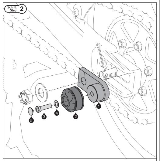
Verschrauben Sie das Achssturzpad (2) mit dem Achsblock (1), wie in der Zeichnung gezeigt.
