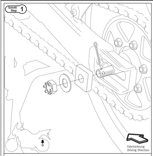
Entfernen Sie vorsichtig den Split der Kronenmutter (linke Fahrzeugseite). Entfernen Sie anschließend den originalen Achsblock und die Unterlegscheibe vom Fahrzeug.
