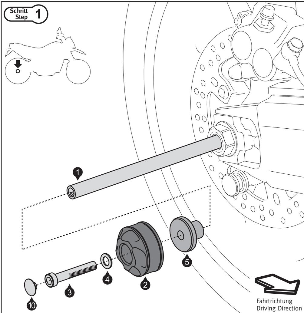
Verschrauben Sie das Achssturzpad mit den gezeigten Komponenten und setzen Sie es auf der rechten Fahrzeugseite ein, wie in der Zeichnung gezeigt.
