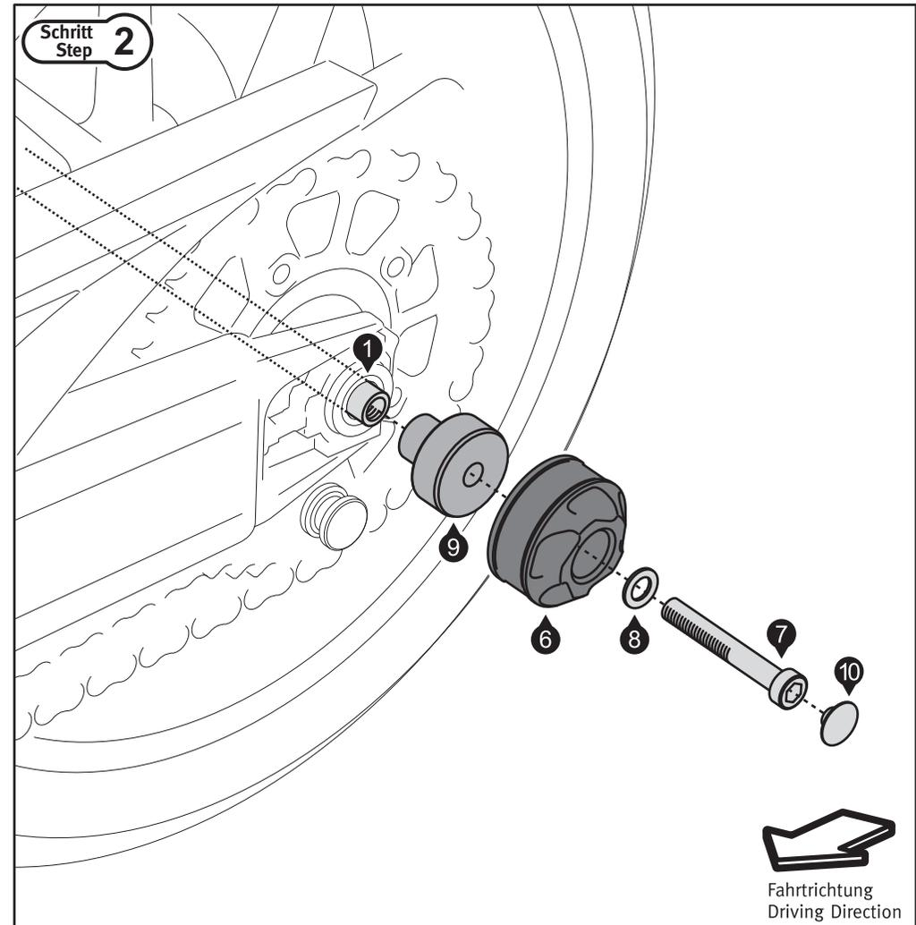
Verschrauben Sie anschließend das Achssturzpad auf der linken Fahrzeugseite, wie in der Zeichnung gezeigt.
