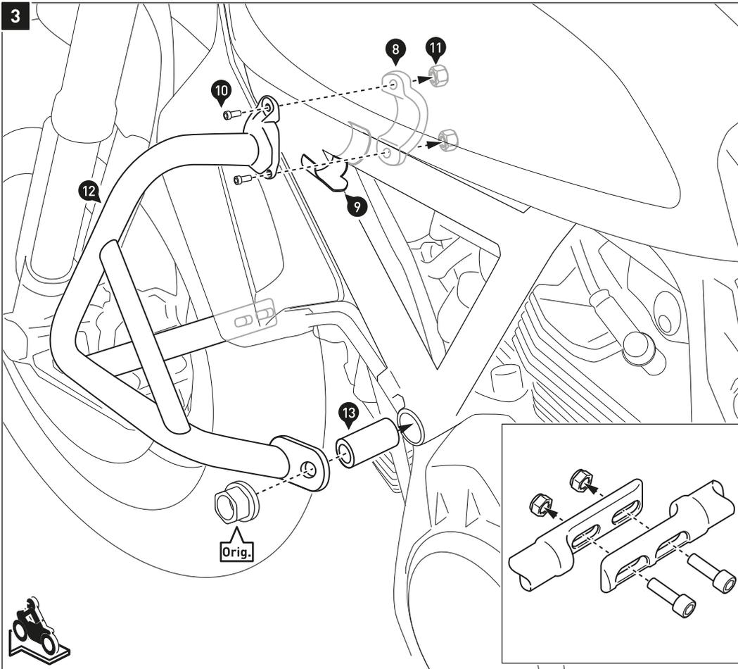
Verschrauben Sie die Teile wie in der Zeichnung dargestellt. Verschrauben Sie die beiden Schutzbügel miteinander wie in der Detailzeichnung gezeigt. Schneiden Sie die Kunststoffabdeckungen gemäß der Vorlage zu und verschrauben Sie diese am Fahrzeug.
