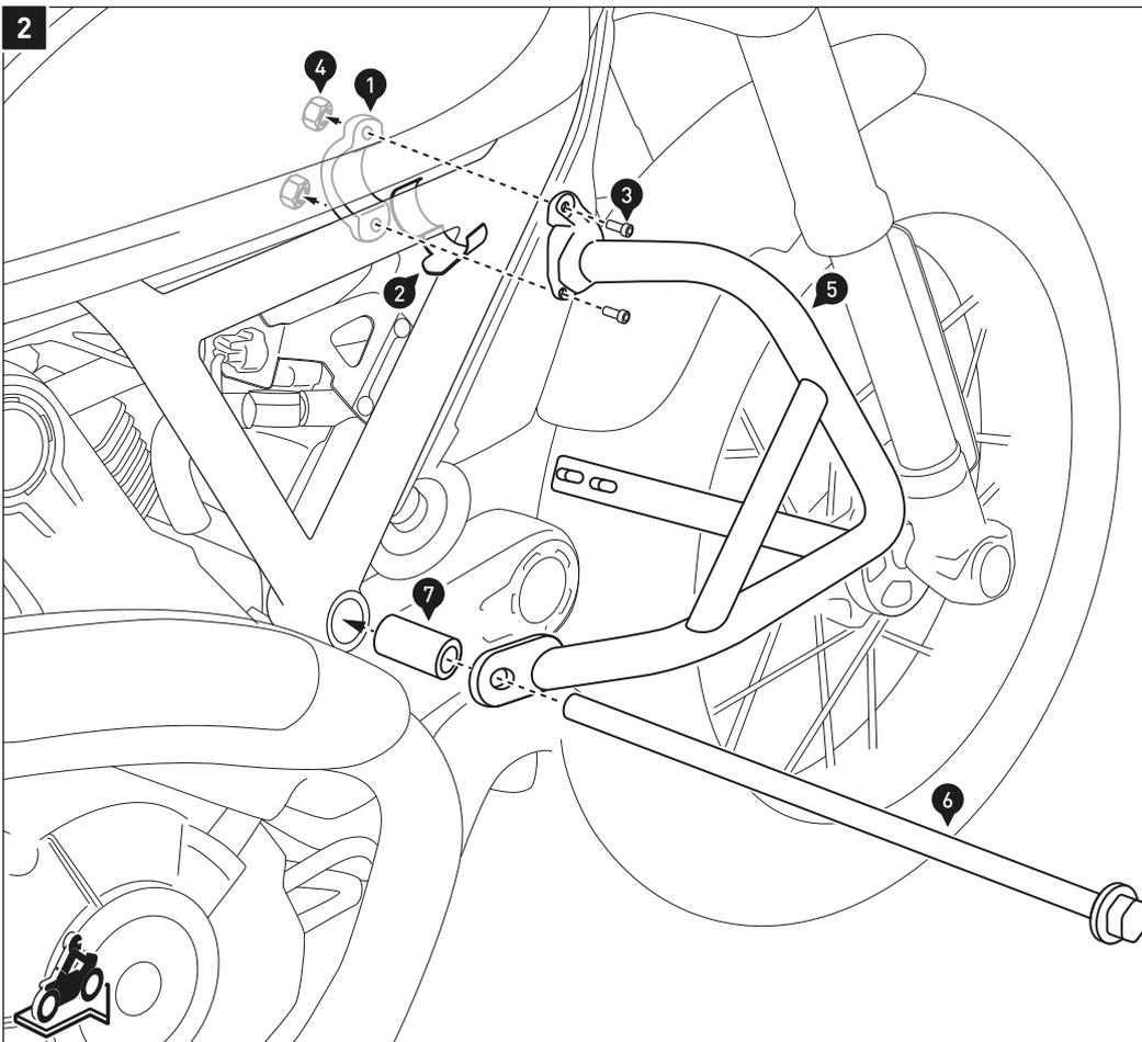
Verschrauben Sie die Teile wie in der Zeichnung dargestellt, indem Sie die originale Motorhalteschraube mit der Schraube (6) heraus schieben.
