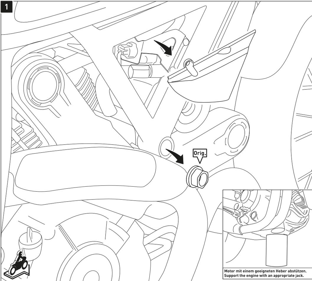
**ACHTUNG: Stützen Sie den Motor mit einem geeigneten Heber ab!**
