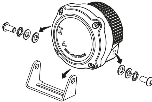
Demontieren Sie die vormontierten Halterungen, wie in der Zeichnung gezeigt.
