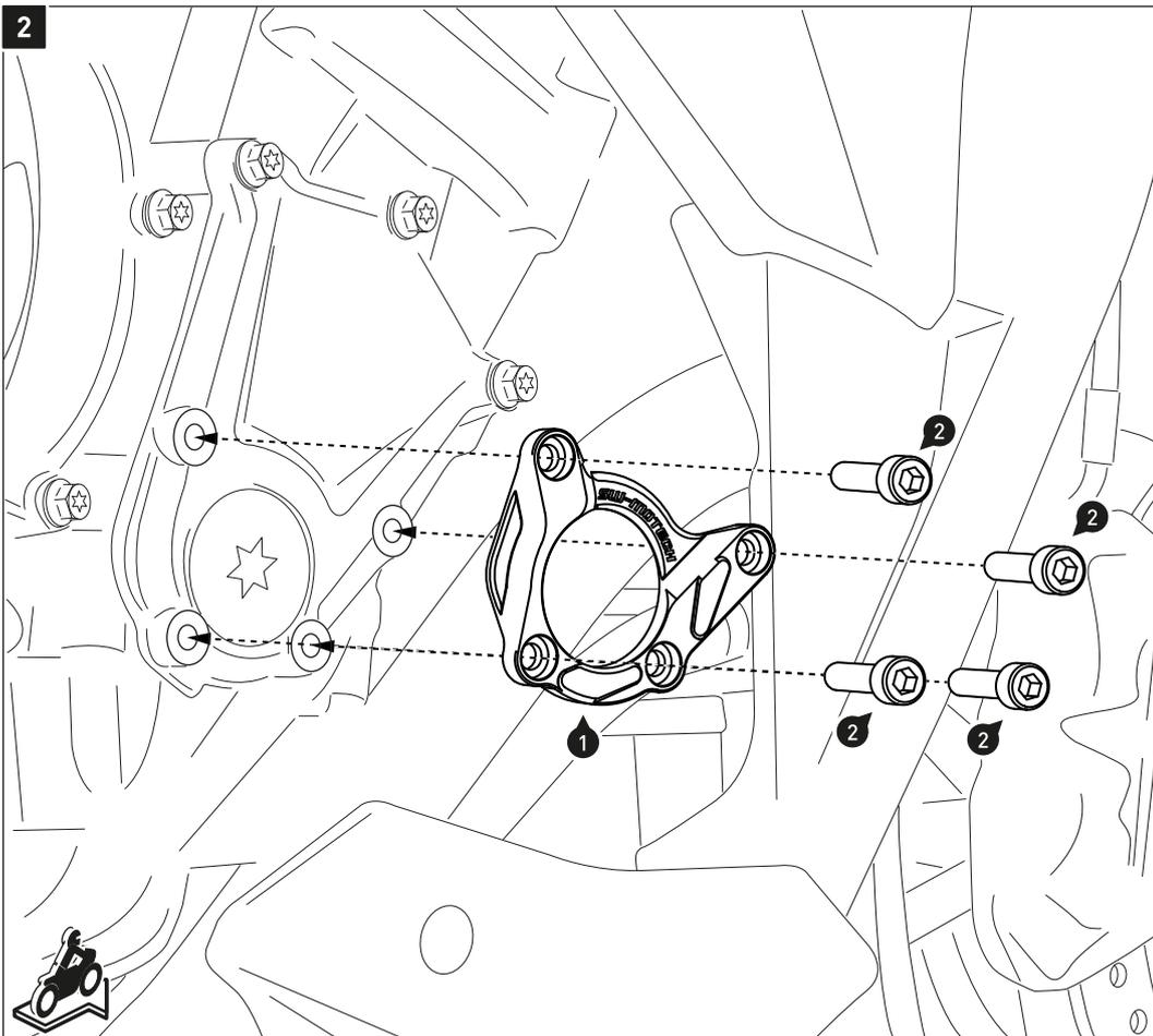
Verschrauben Sie den Motordeckelschutz (1) am Fahrzeug, wie in der Zeichnung dargestellt.
