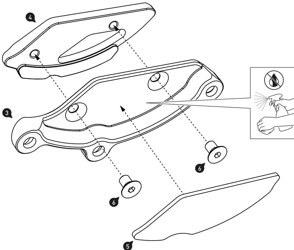
Verschrauben Sie den Motorgehäusedeckelschutz (3) mit dem Motorgehäusedeckelschutz Oberteil (4), wie in der Zeichnung gezeigt.
