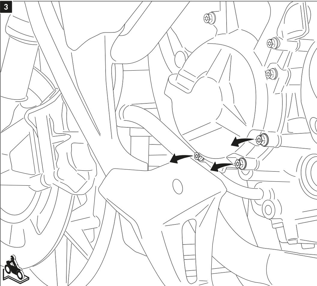
Entfernen Sie die originalen Schrauben von den Anbaupunkten (linke Fahrzeugseite).
