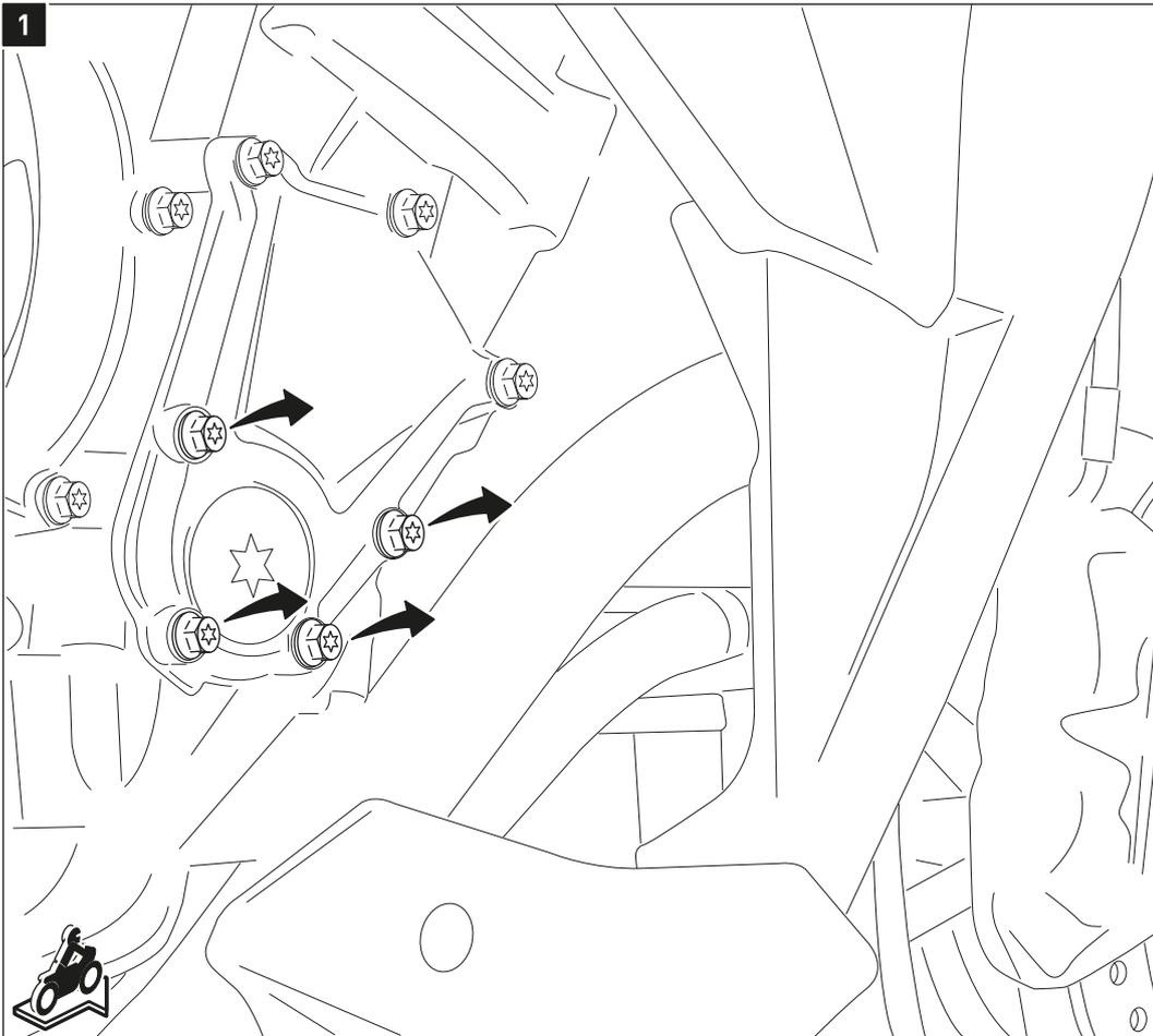
Entfernen Sie die originalen Schrauben von den Anbaupunkten (rechte Fahrzeugseite).
