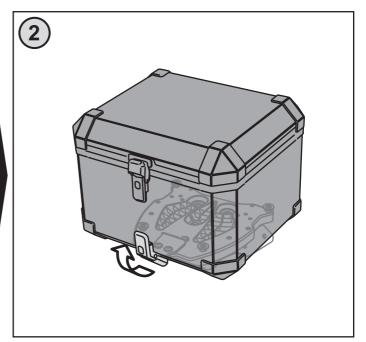
Anschließend den Spannverschluss der TraX ® EVO ALU-BOX wie gezeigt am Vorspannwinkel der QUICK-LOCK Adapterplatte TraX ® einhängen und umklappen. **ACHTUNG:** Achten Sie dabei unbedingt darauf, dass der Spannverschluss ausreichend Spannung hat. Wenn nicht, bitte den Vorspannwinkel nachjustieren. Sichern Sie vor Fahrtbeginn die TraX ® EVO ALU-BOX mit dem TraX ® Schließzylinder-Satz (separat erhältlich).
