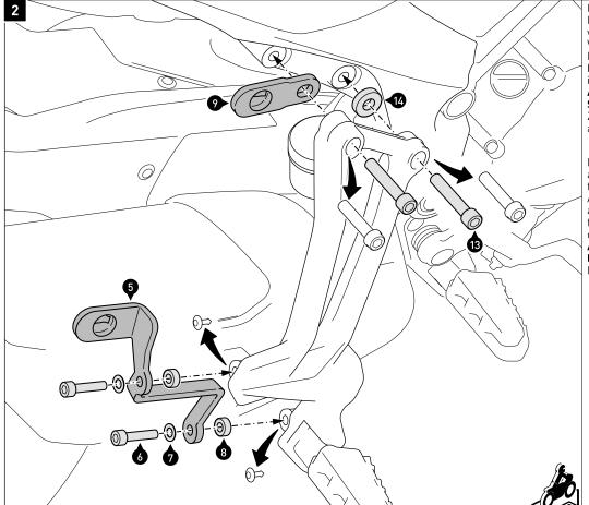
Entfernen Sie die originalen Kunststoffkappen und Schrauben von der Soziusfußraste. Verschrauben Sie nun die Befestigungslaschen (5) und (9) an bzw. hinter der Soziusfußraste, wie in der Zeichnung gezeigt.
