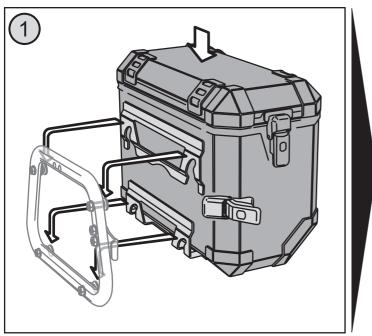
Befestigen Sie das Kofferträger Adapterkit TraX ® (separat erhältlich) am SW-MOTECH QUICK-LOCK EVO Kofferträger / QUICK-LOCK Kofferträger. Anschließend die TraX ® EVO ALU-BOX mit allen vier Befestigunglaschen einhängen und leicht nach unten drücken, bis die TraX ® EVO ALU-BOX feste sitzt.
