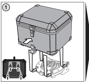
Befestigen Sie die fertig montierte QUICK-LOCK Adapterplatte TraX ® (separat erhältlich) auf Ihrem ALU-RACK. Anschließend die TraX ® EVO ALU-BOX mit allen vier am Boden befindlichen Befestigunglaschen einhängen und leicht nach vorne drücken, bis die TraX ® EVO ALU-BOX feste sitzt
