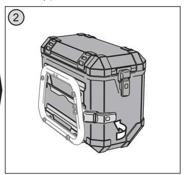
Anschließend den Spannverschluss der TraX ® EVO ALU-BOX wie gezeigt am Vorspannwinkel des Kofferträger Adapterkit TraX ® einhängen und umklappen. ACHTUNG: Achten Sie dabei unbedingt darauf, dass der Spannverschluss ausreichend Spannung hat. Wenn nicht, bitte Vorspannwinkel nachjustieren. Sichern Sie vor Fahrtbeginn die TraX ® EVO ALU-BOX mit dem TraX Schließzylinder-Satz (separat erhältlich).
