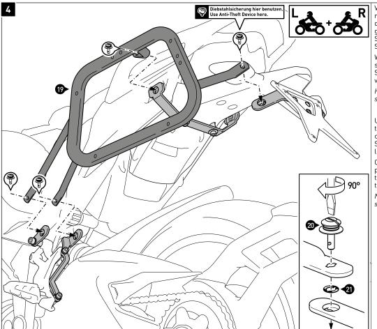
Verbinden Sie die Kofferträger (19) mit den Schnellverschlüssen (20) an den Querverbindern und Befestigungslaschen. Sichern Sie die Schnellverschlüsse mit den Sicherungsscheiben (21).
