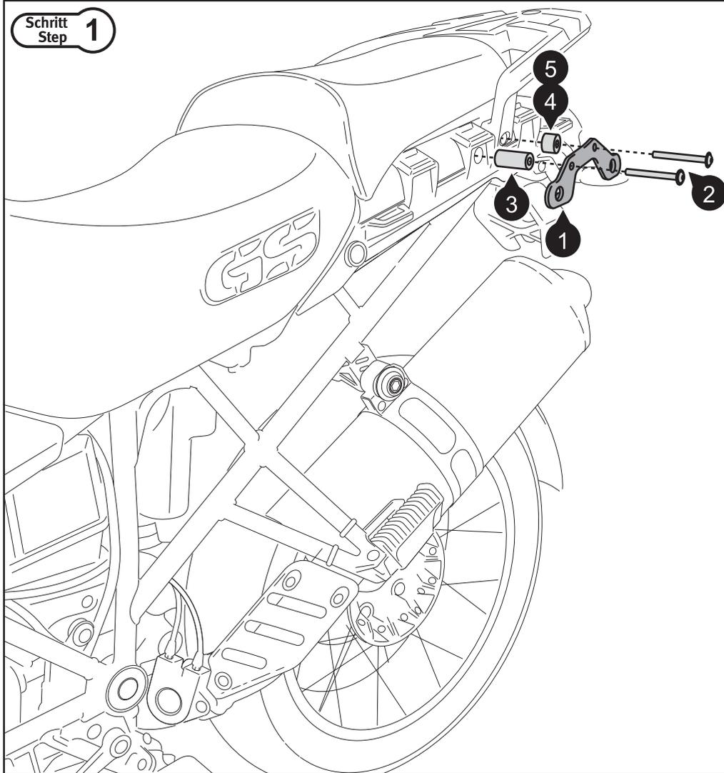
Verschrauben Sie beidseitig die Befestigungsbleche (1) am Fahrzeug. Achten Sie auf die fahrzeugspezifische Verwendung der Distanzbuchsen (4) und (5):
