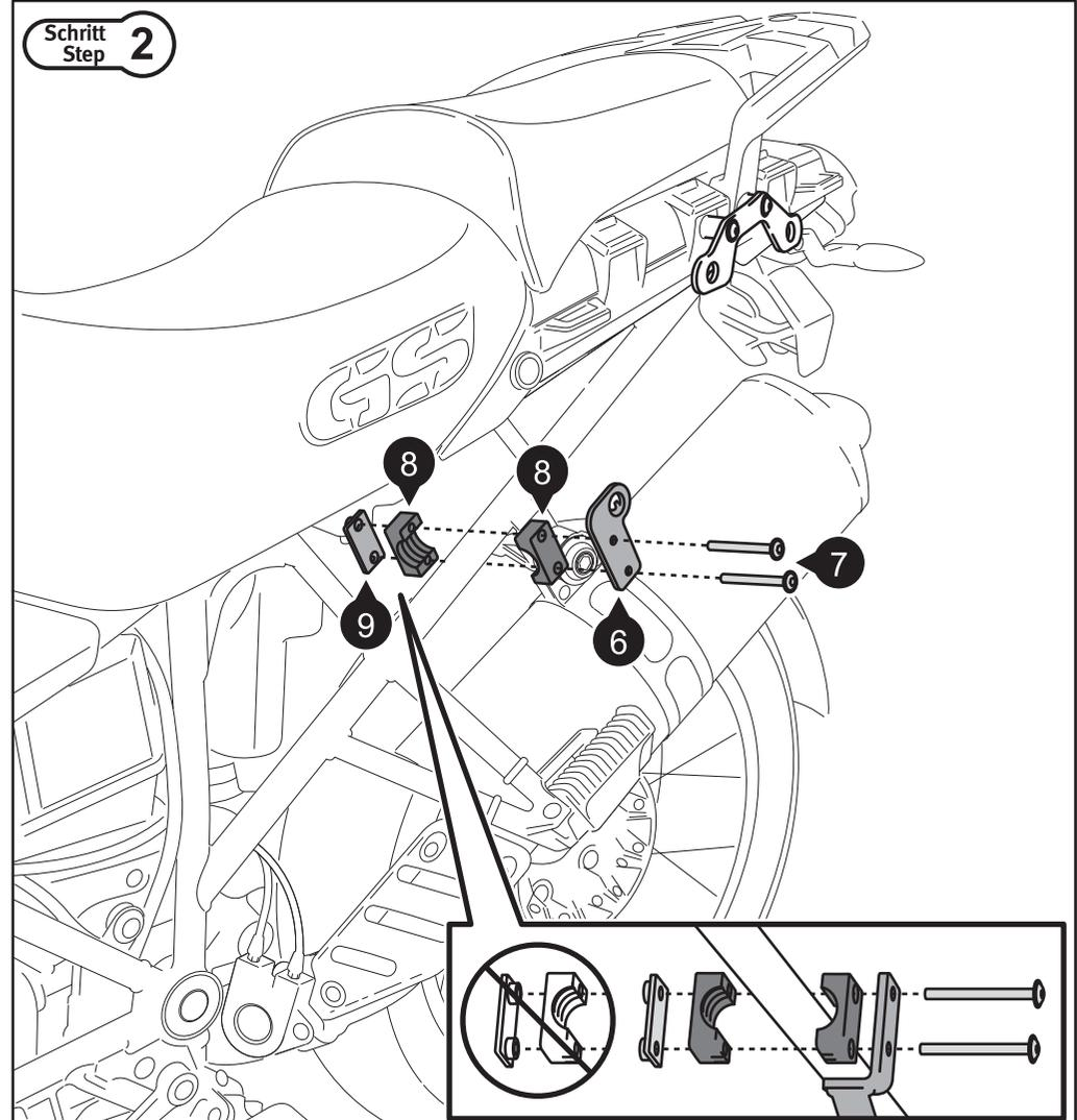
Verschrauben Sie nun beidseitig die Befestigungsbleche (6) am Fahrzeug. Achten Sie auf die Ausrichtung der Verschraubplatten (9) (siehe Detailzeichnung). Sichern Sie alle Gewinde mit flüssiger Schraubensicherung. Ziehen Sie die Schrauben noch nicht an.
