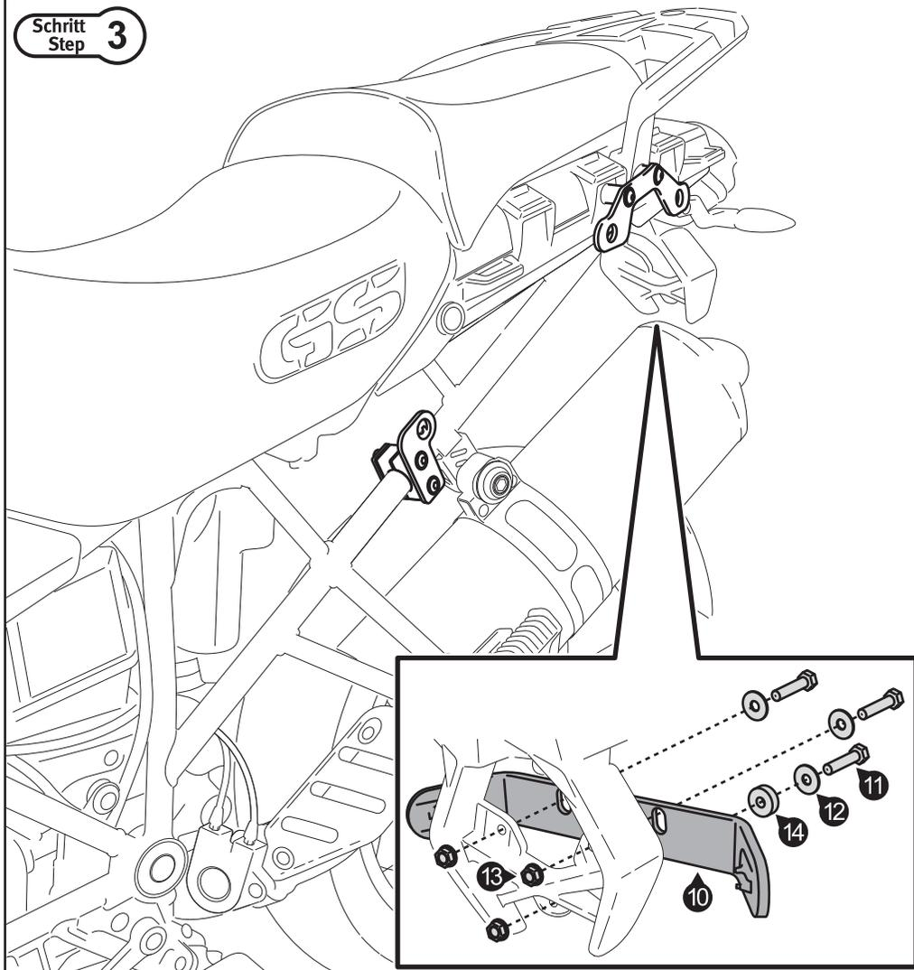
Verschrauben Sie den Querverbinder (10) zwischen Nummernschildhalter und Nummernschild. Die Distanzbuchse (14) kann zum Raumausgleichen unter dem Nummernschild verschraubt werden. Ziehen Sie die Schrauben noch nicht an.
