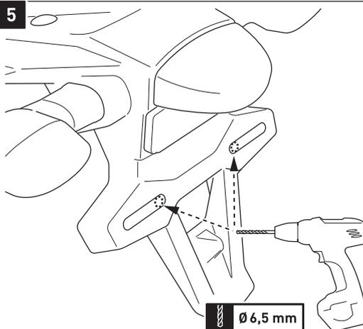
**HINWEIS:** Führen Sie die Schritte 4 & 5 nur durch, falls die Montagebohrungen des Kotflügels nicht mit dem Lochbild des Querverbinders (12) übereinstimmen.
