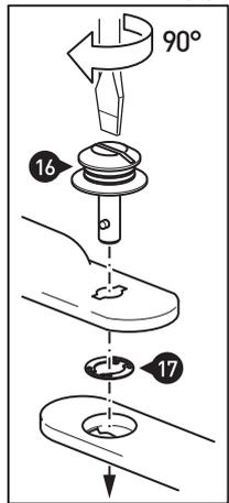
Verbinden Sie die Koffertträger (10) und (11) mit den Schnellverschlüssen (16) an den Befestigungslaschen und dem Querverbinder. Sichern Sie die Schnellverschlüsse mit den Sicherungsscheiben (17).
