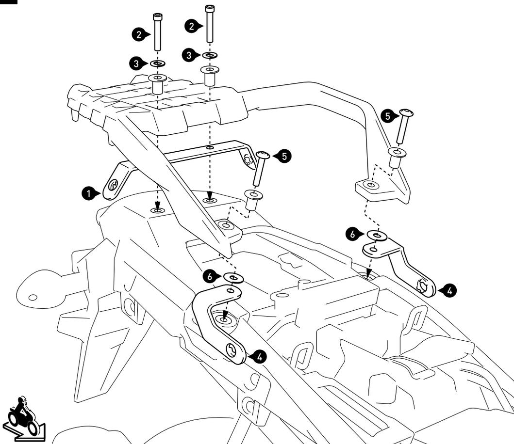
Verschrauben Sie den Querverbinder (1) und die Befestigungslaschen (4) mit den originalen Bundbuchsen und Gepäckträger am Fahrzeug, wie in der Zeichnung gezeigt.
