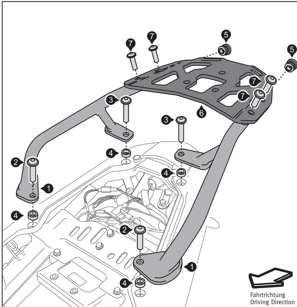
Entfernen Sie die Sitzbank, die originalen Haltegriffe und Distanzbuchsen vom Fahrzeug. Montieren Sie anschließend das ALU-RACK (6), wie in der Zeichnung gezeigt.
