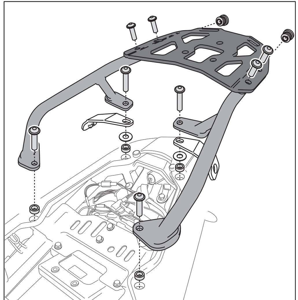
Wenn Sie das ALU-RACK in Kombination mit einem SW-MOTECH QUICK-LOCK Kofferträger nutzen möchten, dann verbauen Sie die Befestigungsbleche und Unterlegscheiben des Kofferträgers wie gezeigt.
