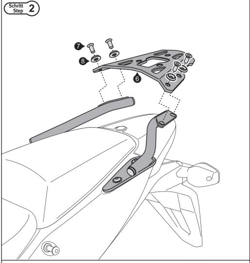
Verschrauben Sie das ALU-RACK wie gezeigt. Sichern Sie die Schrauben mit flüssiger Schraubensicherung. **Anzugsmoment für die Schrauben (7): 20 Nm.**
