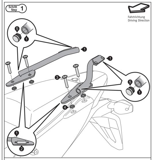
Entfernen Sie die originalen Haltegriffe vom Fahrzeug. Verkleben Sie anschließend die Schonstreifen (2) unter den Haltegriffen (1), wie im Detailbild gezeigt. Montieren Sie die Haltegriffe (1). Sichern Sie die Schrauben mit flüssiger Schraubensicherung.
