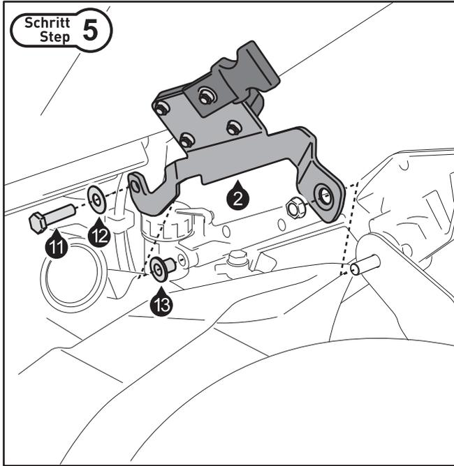
Lösen Sie die originale Schraube und Mutter von den gezeigten Anbaupunkten. Montieren Sie Anbaublech (2) auf der rechten Fahrzeugseite hinter dem Fußrastenhalter, wie in der Zeichnung gezeigt. Verwenden Sie für die Montage die originale Auspuffhalteschraube und Mutter. **Ziehen Sie die Schraube (11) wie vorgegeben an: 6 Nm. Benutzen Sie flüssige Schraubensicherung.** Verschrauben Sie alle in Schritt 4 gelösten Teile wieder am Fahrzeug.
