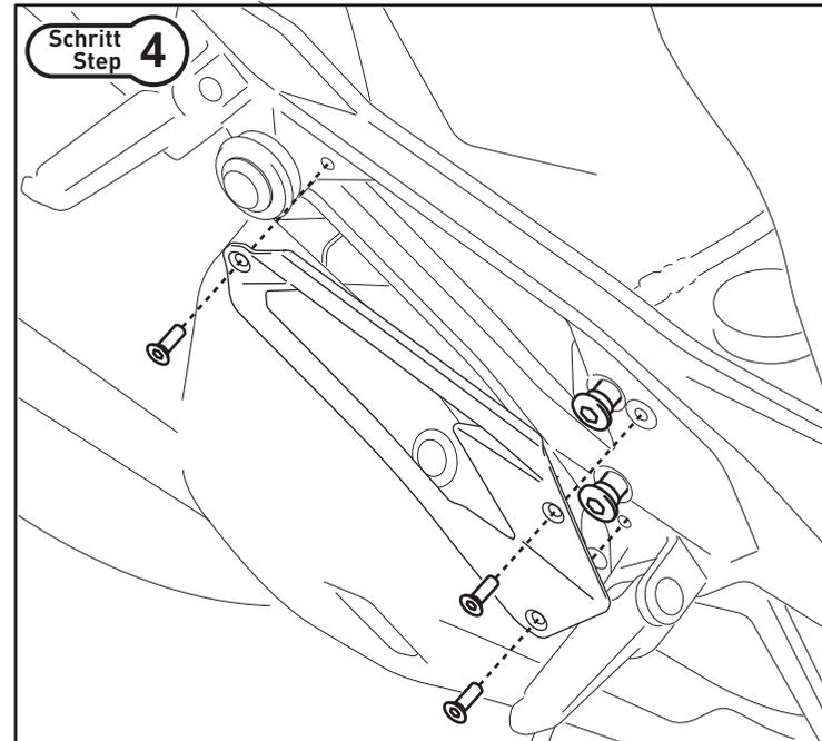
Lösen Sie die originalen Schrauben des gezeigten Verkleidungsteils und entfernen Sie dieses vom Fahrzeug (Fußrastenhalter rechts).
