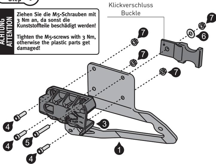
Montieren Sie die gezeigten Teile an Anbaublech (1). Entnehmen Sie den Klickverschluss Ihren Satteltaschen und verschrauben Sie diesen wie gezeigt. Die Schrauben (5) erst nach Befestigung der Satteltaschen anziehen.
