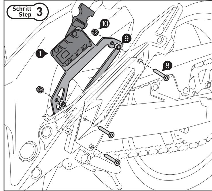
Lösen Sie die originalen Schrauben von den gezeigten Anbaupunkten. Montieren Sie Anbaublech (1) auf der linken Fahrzeugseite hinter dem Fußrastenhalter, wie in der Zeichnung gezeigt. Ziehen Sie die Schrauben wie vorgegeben an: 5,5 Nm.
