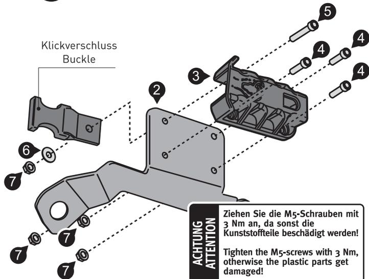
Montieren Sie die gezeigten Teile an Anbaublech (2). Entnehmen Sie den Klickverschluss Ihren Satteltaschen und verschrauben Sie diesen wie gezeigt. Die Schrauben (5) erst nach Befestigung der Satteltaschen anziehen.
