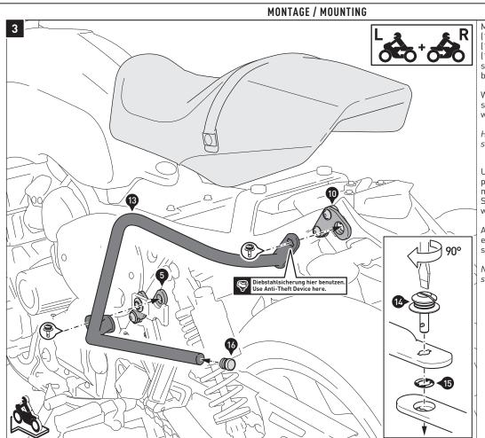
Montieren Sie die Abstandsbügel (13) mit den Schnellverschlüssen (14) an den Anbaublechen (5) und (10). Sichern Sie die Schnellverschlüsse mit den Sicherungsscheiben (15).
